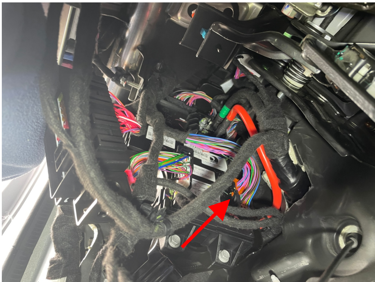
Widok od tyłu wtyku (przewodów wchodzących w styki wtyku)
